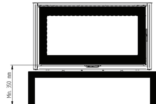
Ein Abstand von mindestens 350 mm von der Unterkante der Tür bis zum Boden und min. 530 mm Abstand zu nicht brennbarem Boden vor dem Ofen. (z. B. Klinken, Fliesen usw. auf Betonuntergrund) ist erforderlich. Wird der Mindestabstand min. 350 mm (zwischen Boden und Türunterkante) auf min. 460 mm vergrößert, bestehen keine besonderen Anforderungen an das Bodenmaterial.
