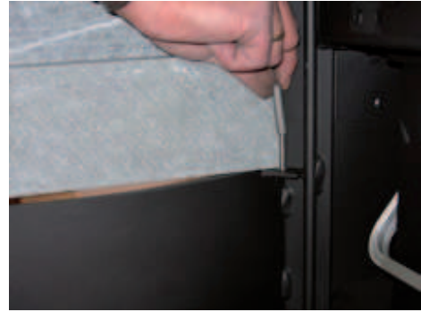
38. Die beiden Röhrchen über die Pinolschrauben stülpen, so dass der Stein stabil befestigt ist.
