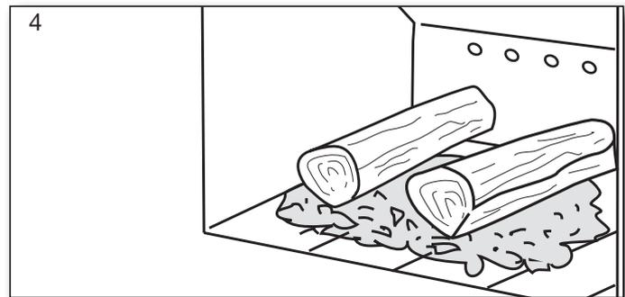
Placer une couche de bûches env. 1,2 kg sur les braises, perpendiculairement à la porte de chargement.
