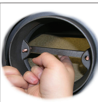
Fig. 7 Spænd røgtuden fast bag på ovnen med holderen eller bolte.
