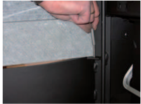
38. Når stenen sidder, hvor den skal, skal skruerne igen spændes forsigtigt, så stenen ikke kan give sig.
