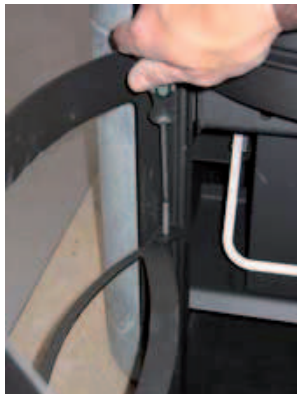
36. Før montage af den lodrette sten i askelågen, skal skruen løsnes.
