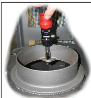
Fig. 4 Løsn boltene i røgtuden ovenud.
