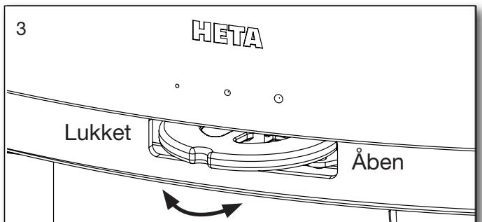
Ovnen tilføres forbrændingsluft, ved hjælp af håndtaget under indfyringslågen. Se fig. 3.
