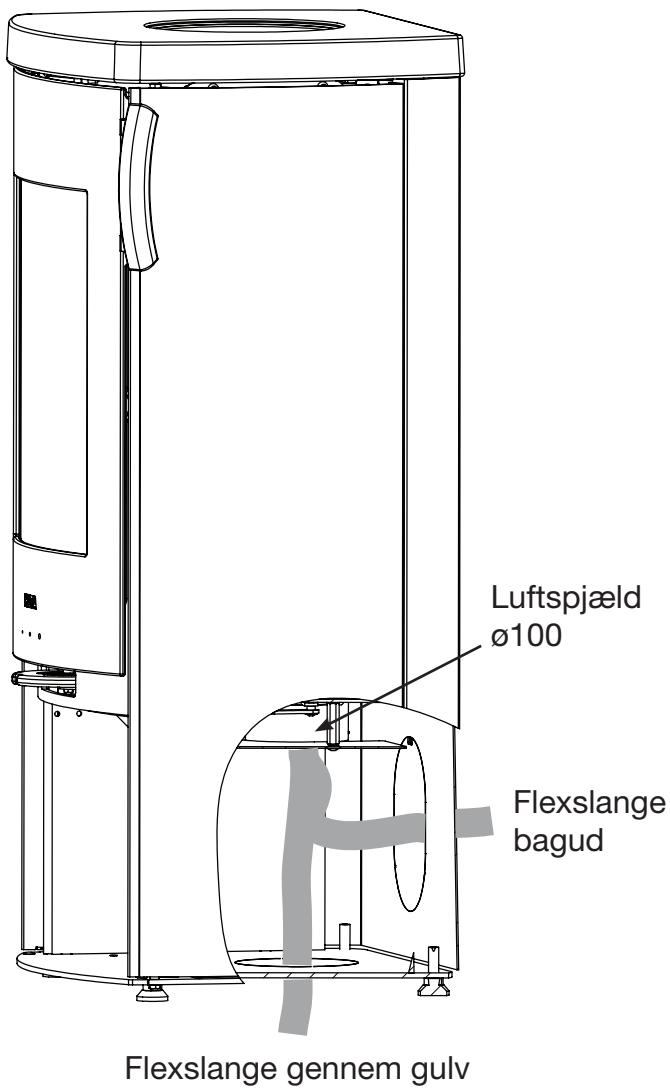
Ved montering af ekstern lufttilførsel kan der føres en flexslange fra luftregulering til luftudgang bag ovnen.
