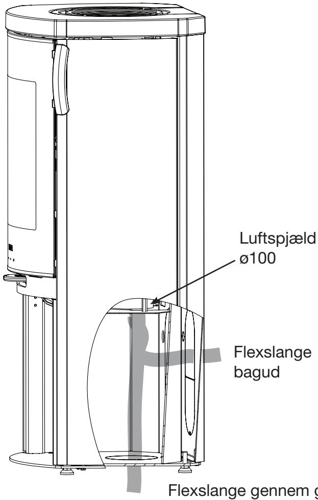
Ved montering af ekstern lufttilførsel kan der føres en flexslange fra luftregulering til luftudgang bag ovnen.
