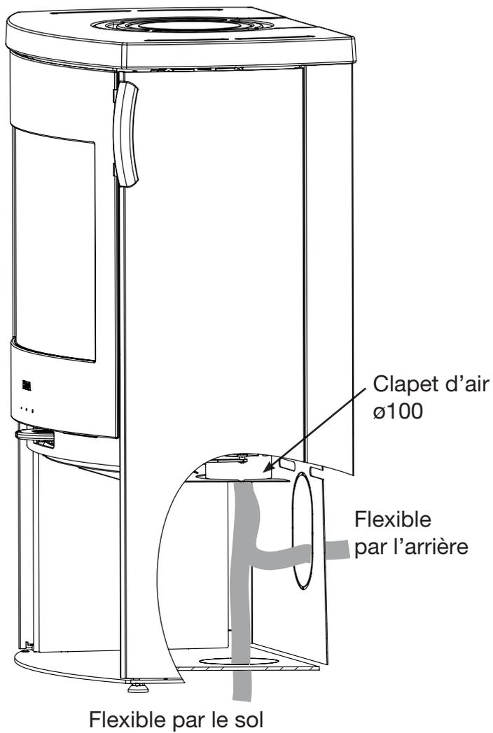
Lors de l'installation d'une alimentation en air externe, un tuyau flexible de contrôle de l'air peut être installé à la sortie d'air derrière le four.
