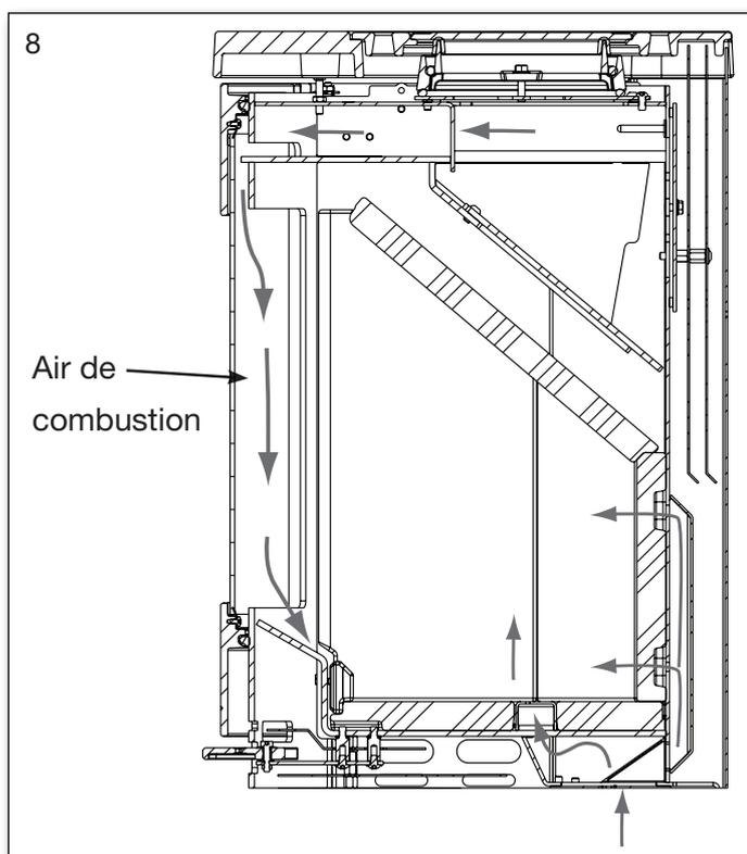
rendement élevé et la vitre reste propre en étant balayé par l'air secondaire.
