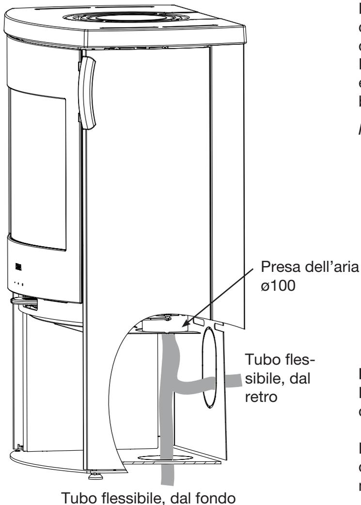
Per il montaggio di una presa d'aria esterna, collegare un tubo flessibile dalla regolazione dell'aria allo scarico dell'aria dietro la stufa. Inoltre, è possibile montare la presa d'aria esterna attraverso il fondo con un tubo flessibile.
