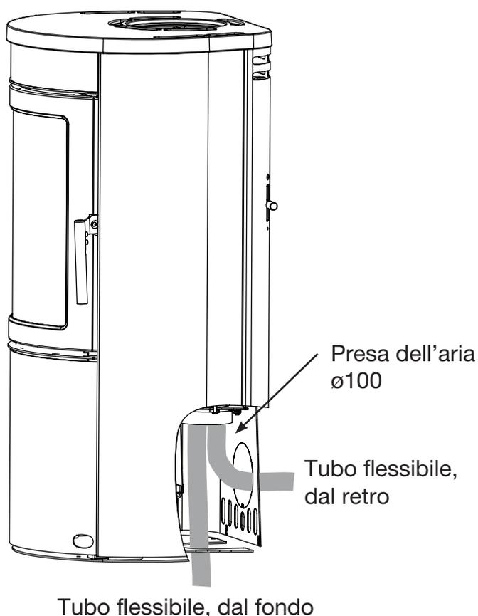
Per il montaggio di una presa d'aria esterna, collegare un tubo flessibile dalla regolazione dell'aria allo scarico dell'aria dietro la stufa. Inoltre, è possibile montare la presa d'aria esterna attraverso il fondo con un tubo flessibile.
