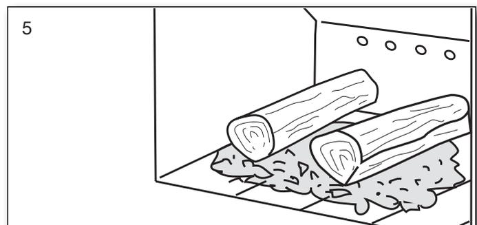
Pezzi di combustibile da 1,2 kg vanno collocati sopra le braci in uno strato perpendicolare rispetto alla porta.
