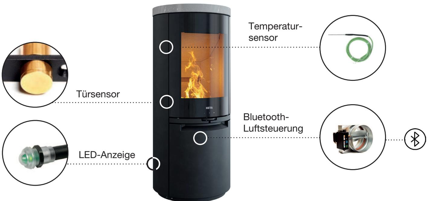
**Der magnetische Türsensor** erkennt, wenn Brennstoff angezündet wird, und leitet direkt einen neuen Brennzyklus ein. Für diesen automatischen Vorgang ist weder Telefon noch Tablet erforderlich. Der Brennzyklus wird anhand der Farbcodes auf der LED-Anzeige angezeigt.
