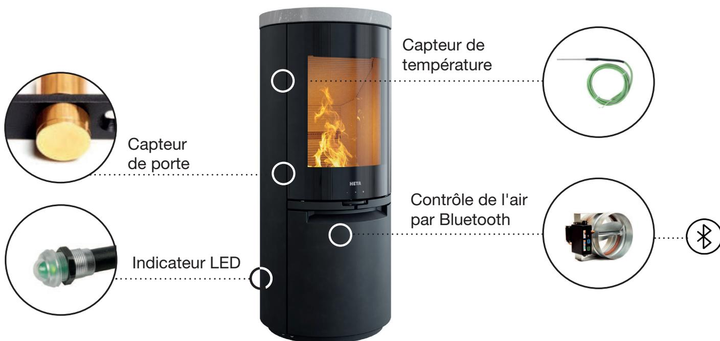
**Le capteur magnétique** de la porte détecte l'allumage du bois de chauffage et démarre un nouveau cycle de combustion. Il est automatique et ne nécessite ni téléphone ni tablette. Le cycle de combustion est indiqué par les codes de couleur sur l'indicateur LED.
