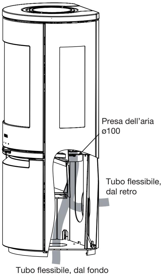
Per il montaggio di una presa d'aria esterna, collegare un tubo flessibile dalla regolazione dell'aria allo scarico dell'aria dietro la stufa. Inoltre, è possibile montare la presa d'aria esterna attraverso il fondo con un tubo flessibile.
