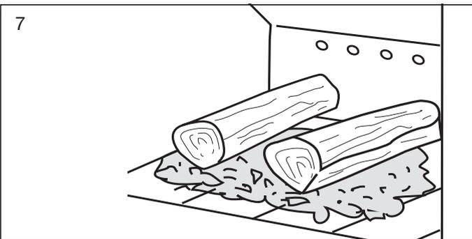
Le bois durcira assez rapidement (entre 30 secondes et 1 minute). Réglez ensuite l'air de combustion au niveau souhaité. Le rendement nominal (4,5 kW) correspond à un air de combustion ouvert à 50 % et un air de démarrage fermé.
