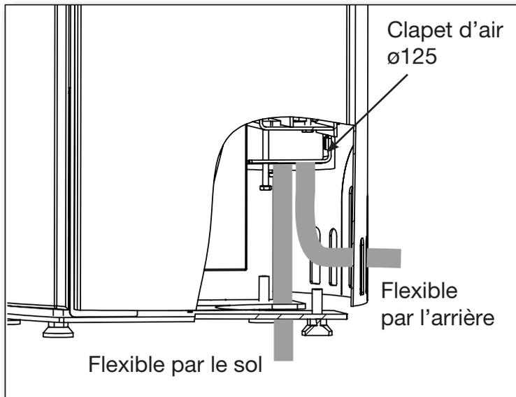
Lors de l'installation d'une alimentation en air externe, un tuyau flexible de contrôle de l'air peut être installé à la sortie d'air derrière le four.
