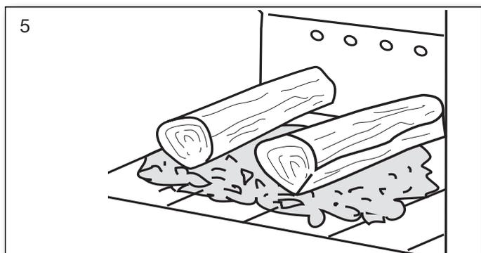
di braci. Distribuire le braci sul fondo, ma principalmente nella parte anteriore della stufa. Collocare una quantità di ceppi corrispondenti a 1,42 kg per Scan-Line 800IT e a 1,52 kg per Scan-Line 800 con finestre laterali, sopra le braci in perpendicolare rispetto all'apertura della stufa. Vedere fig. 5. Aprire l'aria di combustione completamente e mantenere l'eventuale sportello socchiuso (non è necessario mantenerlo socchiuso, ma può accelerare l'accensione del combustibile).
