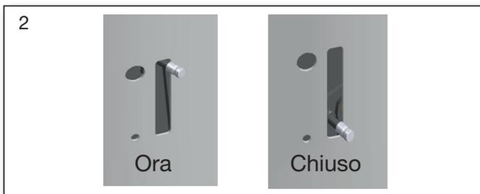
L'aria di combustione è completamente aperta nella posizione più alta.
