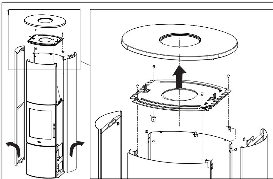
Rimozione delle sponde in acciaio
